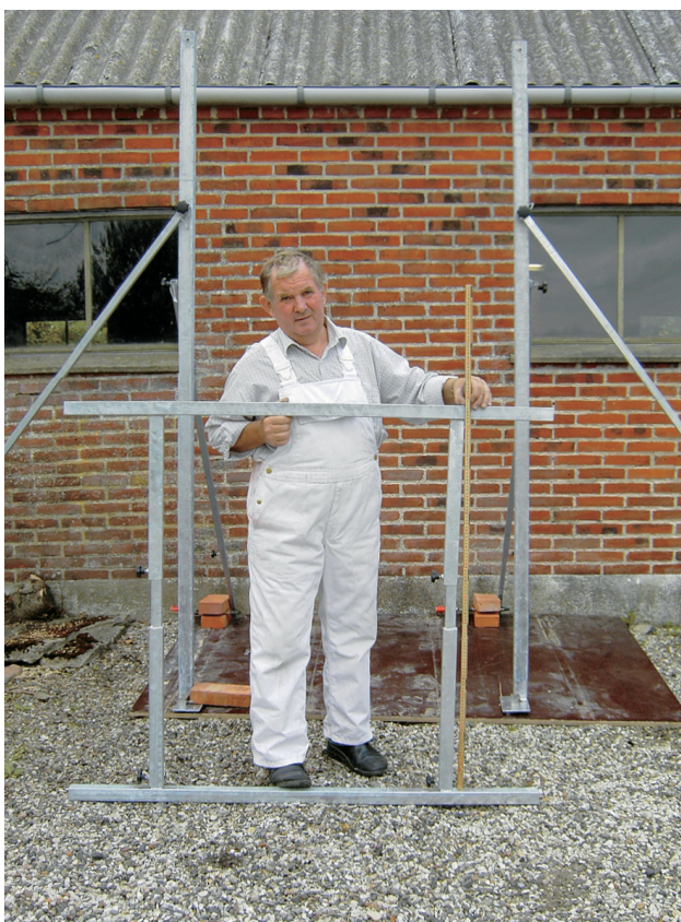
Nem indstilling af vinduesramme. Ved opmåling af bredde sættes tommestokken på indvendig side og 4 cm trækkes fra
