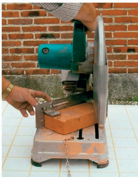
3. mærke for skæring af sten til \frac{3}{4} sten 16,8 cm - 4,8 cm
