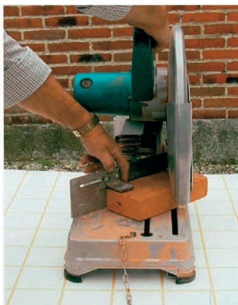
2. mærke for skæring af sten til \frac{1}{2} sten 10,8 cm - 4,8 cm
