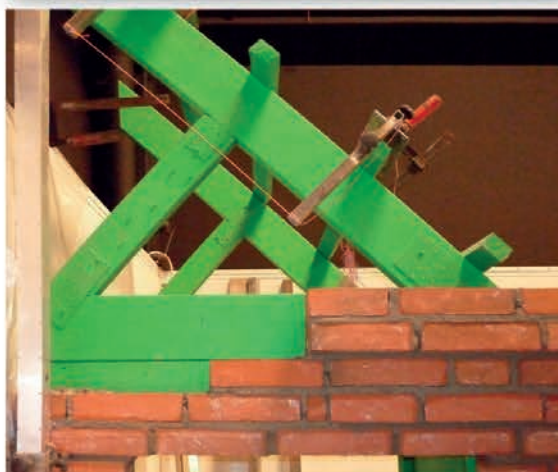
Billedet i midten: Snoren er rykket ud, så første sten lægges efter snoren
