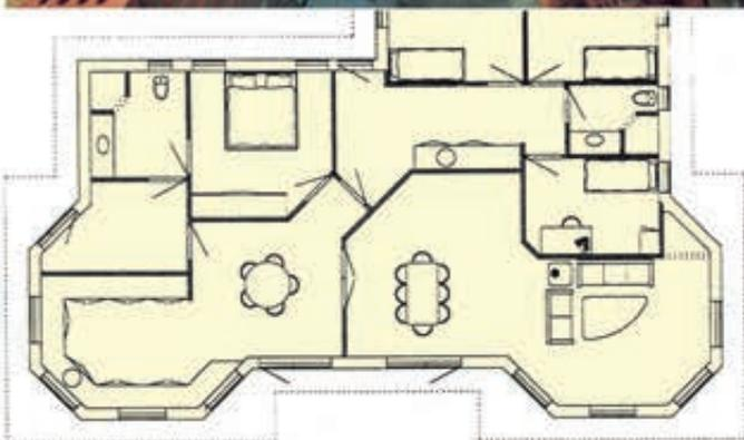
Ein Haustyp, bei dem sich aus dem Einsatz von Guldborg-Maurerecken große Vorteile dank der schnellen Montage von vier Innenecken ergeben, die im Rahmen eines Arbeitsvorgangs ohne aufwendiges Versteifen aufgemauert werden können. Nach außen hin kann das Aufmauern ebenfalls als ununterbrochener Vorgang erfolgen.
