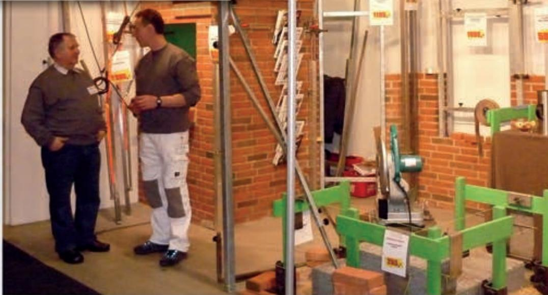
Die Maurerecken wurden als Vierkantprofil 50 x 50 x 3 mm ausgeführt. Stahl, feuerverzinkt, nichtrostend und Alu 4 mm. Einstellen mittels Teleskopstangen oder Wandkonsolen, die an der Hintermauer zu befestigen sind.
